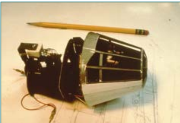
Мелкомасштабный макет. Задняя приборная панель освещена яркой галогеновой лампочкой
